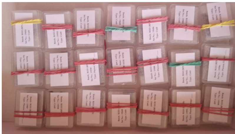
Рис. 1. Партия дозиметров из МАГАТЭ для проведения дозиметрического аудита.
